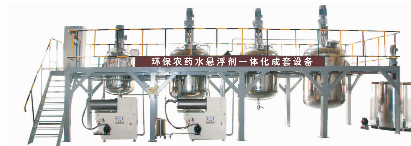
A: 环保农药水悬浮剂一体化成套设备流程图 SC formulation plant layout
